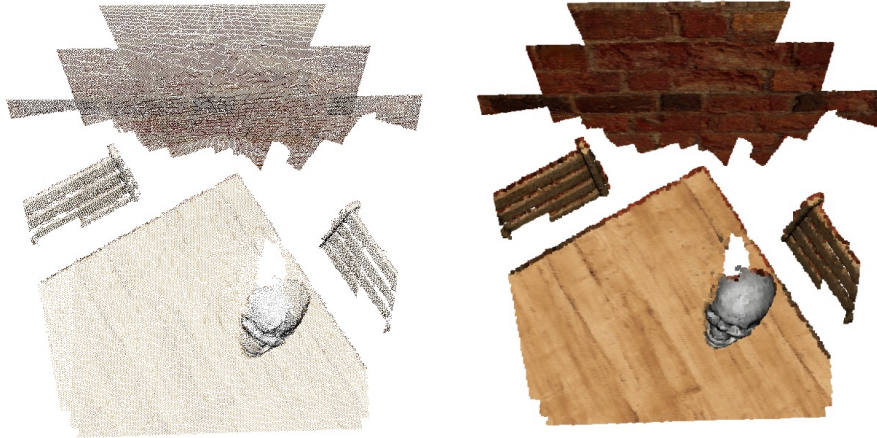
Fig. 3.3 – Résoudre le problème de sparsité du nuage de points. À droite la scène skull reconstruite grâce à PMVS (Furukawa et Ponce, 2010). La densité du nuage n'est pas, telle quelle, suffisante pour produire un rendu de qualité. (b)
