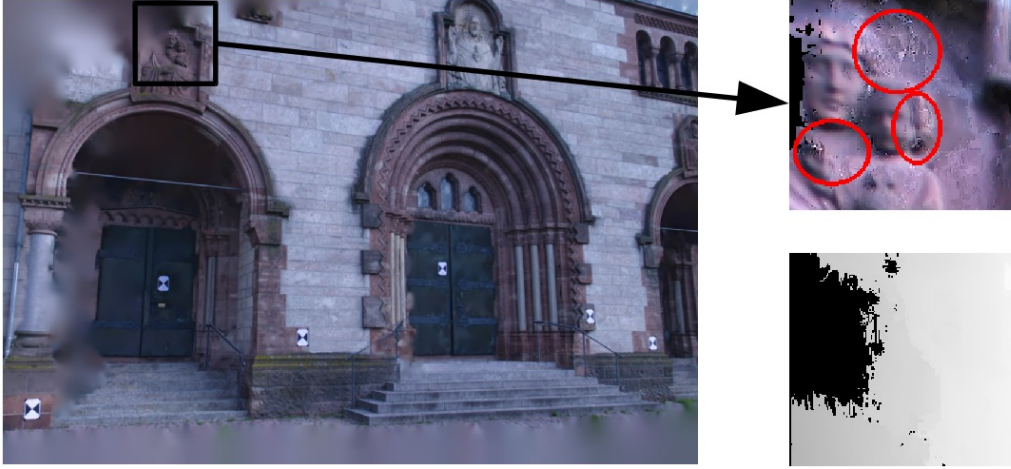
Fig. 5.3 – Les discontinuités des warps \tau_k et des poids \omega_k provoquent des artefacts. À gauche: la vue globale d'une scène de Strecha et al. (2008) estimée avec l'énergie donnée par l'équation 5.19. En haut à droite: un zoom révèle des artefacts haute-fréquence. En bas à droite : une carte de profondeur présentant des discontinuités dues à la visibilité à cet endroit de l'image.
